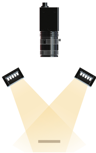
Bright Field 양방향 설치
